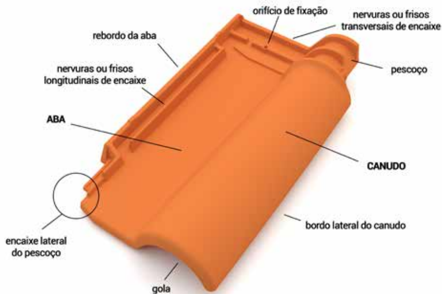
Partes da Telha Lusa de Aba e Canudo
