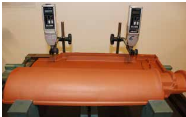
Ensaio dimensional da telha
