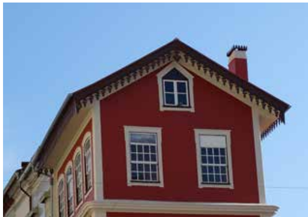
Telhados de 2 e 4 águas
