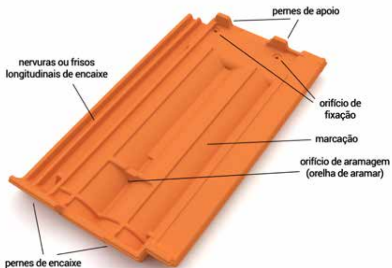
Partes da Telha Marselha
